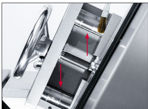
Rys. 9-12 Smarowanie prowadnic i wrzecion regulacyjnych regulacji kąta
