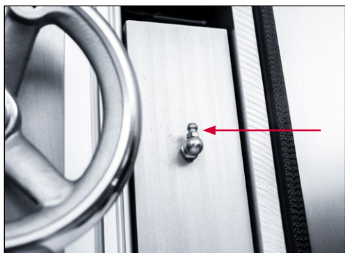
Rys. 9-10 Smarowanie przedniej obudowy prowadnicy
