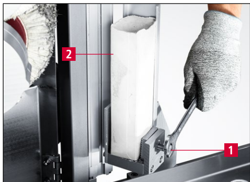
Rys. 7-79 Wymiana pasty polerskiej jednostki polerującej
