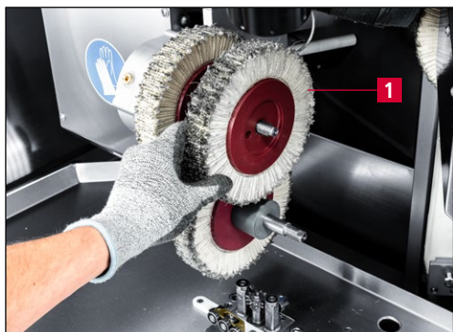
Rys. 7-74 Zdejmowanie górnej szczotki gratującej
