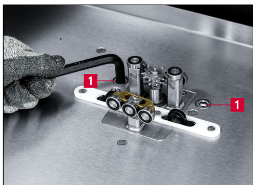
Rys. 9-6 Odkręcanie blachy ślizgowej
