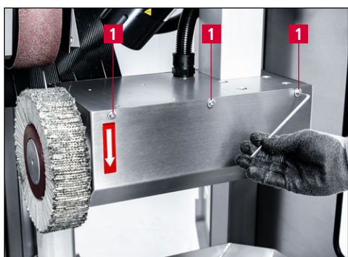
Rys. 9-16 Zdejmowanie pokrywy jednostki polerującej
