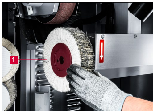
Rys. 7-67 Wymiana szczotki polerskiej
