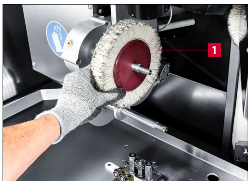
Rys. 7-78 Zdejmowanie górnej szczotki gratującej
