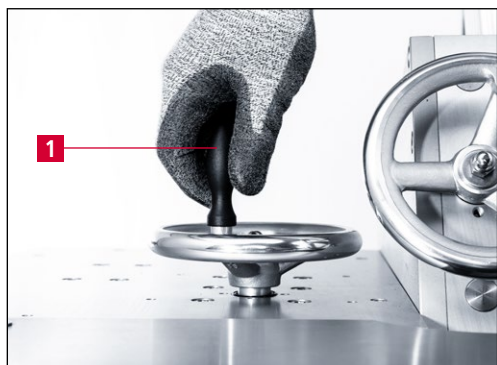
Rys. 7-42 Regulacja wysokości jednostki gratującej
