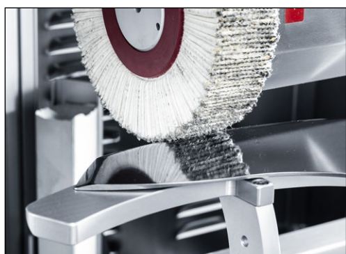
Rys. 7-21 Szczotka polerska przylegająca do noża
