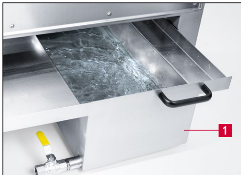
9-21 pav. Aušinimo skysčio keitimas
