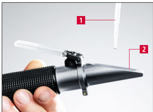
9-22 pav. Aušinimo tepalo koncentracijos matavimas
