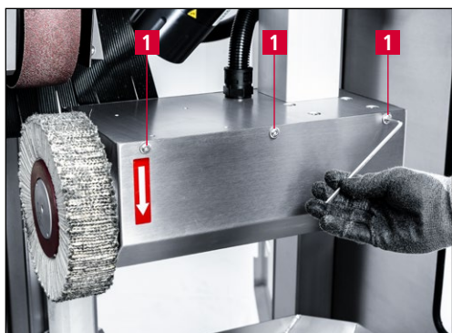
9-16 pav. Poliravimo įrenginio dangtelio nuėmimas
