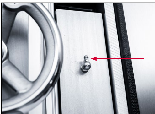
9-10 pav. Prispaudžiamo kreipiamojo korpuso priekyje tepimas
