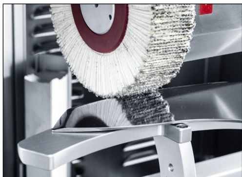
Фиг. 7-21 Полиращата четка приляга върху ножа
