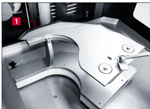
Фиг. 7-31 Затягане на нож
