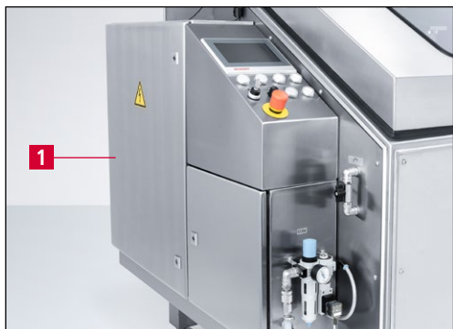
Фиг. 8-34 Разпределителен шкаф
