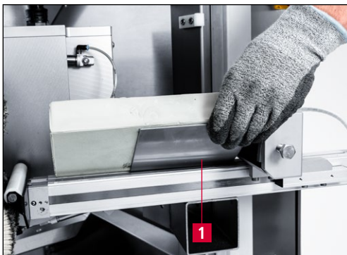
Bild 7-81 Polierpaste Entgrateinheit wechseln
