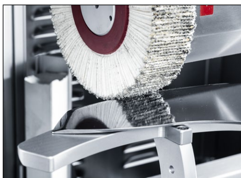
Bild 7-21 Polierbürste liegt auf dem Messer auf
