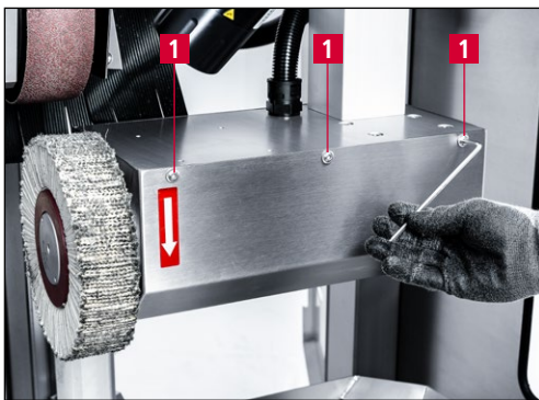
Bild 9-16 Abdeckung Poliereinheit abnehmen
