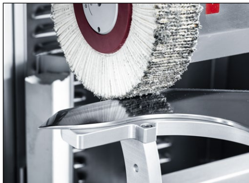
Bild 7-47 Polierbürste liegt auf dem Messer auf
