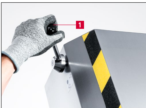
Bild 7-60 Bandentlastungshebel nach oben schwenken
