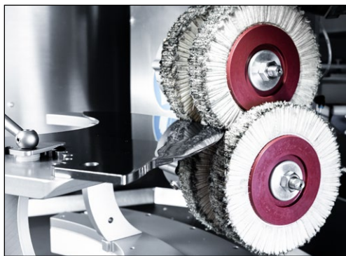
Bild 7-17 Messerschneide liegt im Schnittpunkt der Entgratbürsten
